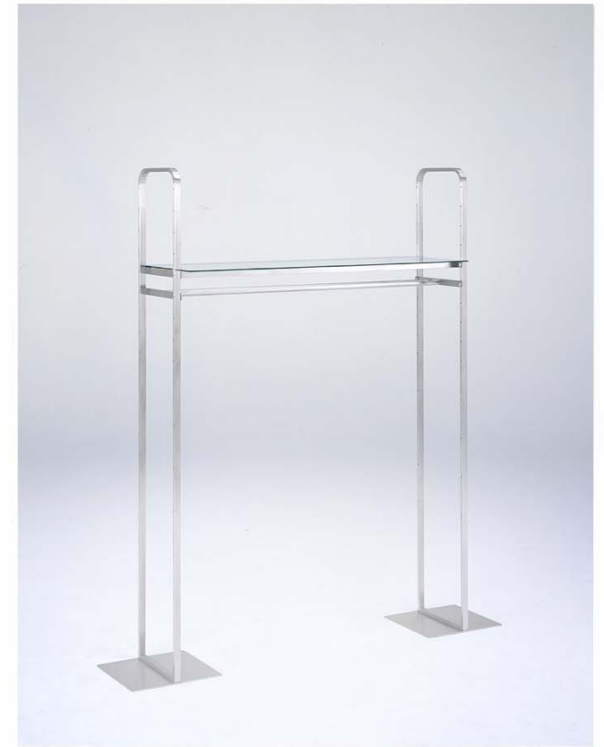
MODEL-10 本体 ステンレス・HL仕上げ／棚板 透明ガラス8t／ハンガー ステンレス・HL仕上げ／ 棚受 ステンレス・HL仕上げ W1578 D400 H1800
