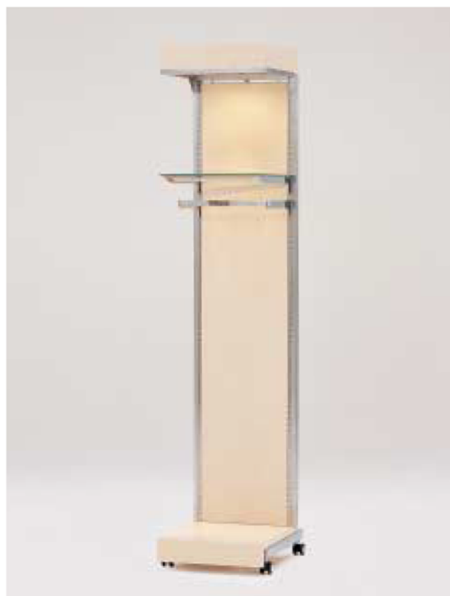
MODEL-32 本体 ステンレス・HL仕上げ / パネル、ステージ 木・ポリ合板 (オーク) / パラペット 木・ポリ合板 (オーク)・照明 / 棚 透明ガラス8t / ハンガー ステンレス・HL仕上げ / 他 スチール・Crメッキ W458 D545 H2150
