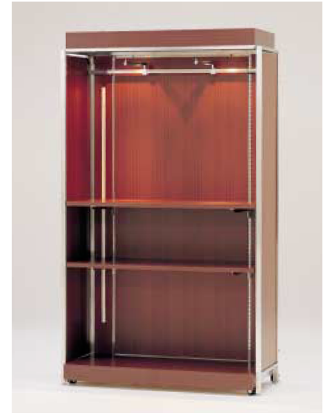
MODEL-27 本体, サイドフレーム ステンレス・HL仕上げ / パネル, 棚, ステージ 木・ポリ合板(マホガニー) / パラペット 木・ポリ合板(マホガニー)・照明 / ハンガー ステンレス・HL仕上げ / 他 スチール・Crメッキ W1265 D545 H2150
