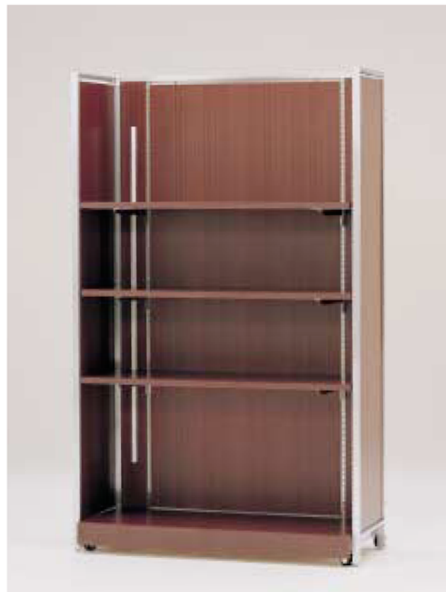
MODEL-25 本体, サイドフレーム ステンレス・HL仕上げ / パネル, 棚, ステージ 木・ポリ合板(マホガニー) / 他 スチール・Crメッキ W1265 D545 H2050
