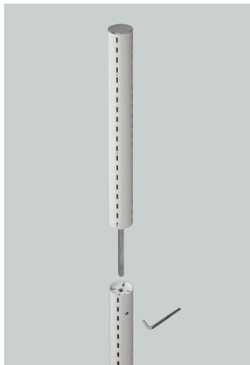
本体ポール上部のTOPキャップを外し、H500のTOPジョイントパイプを差し込んで横穴の固定ネジを六角レンチで固定すればH2100・H1850のポール本体としてご使用できます。
