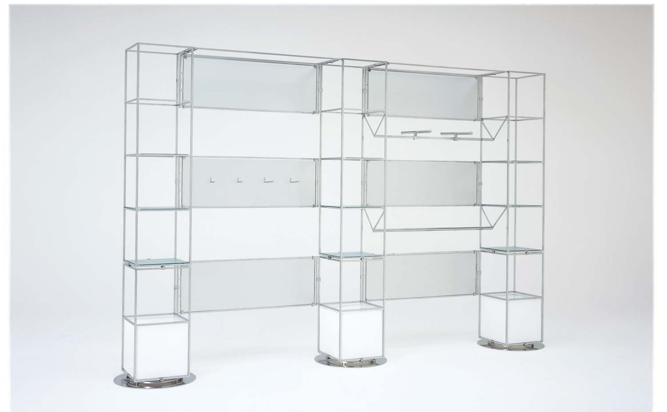
MODEL-3 本体 スチール・粉体塗装(ホイールシルバー) / ジョイント 樹脂 / パネルジョイント スチール・Crメッキ / 棚フレーム スチール・粉体塗装(ホイールシルバー) / 棚板 アルミ・アルマイト仕上げ / 棚板 タペストリーガラス5t / ハンガー スチール・Crメッキ / アクリルBOX 骨白アクリル5t W4066 D630 H2582
