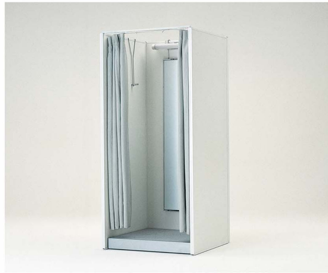
MODEL-3 本体パネル アルミ・焼付塗装(白)・ペーパーハニカム/ミラー/ステージ ホ・ラッカー塗装(シルバーメタリック)/カーテン 布・グレース/照明 W967 D967 H2100
